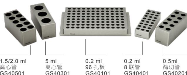
\* 金属管架置于底座上，使用前无需冷冻。
